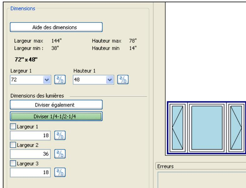
Figure 25 : Modification des dimensions de modules
