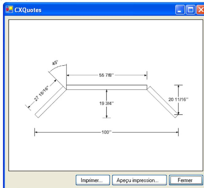
Figure 26 : Vue d'élévation des fenêtres en baie
